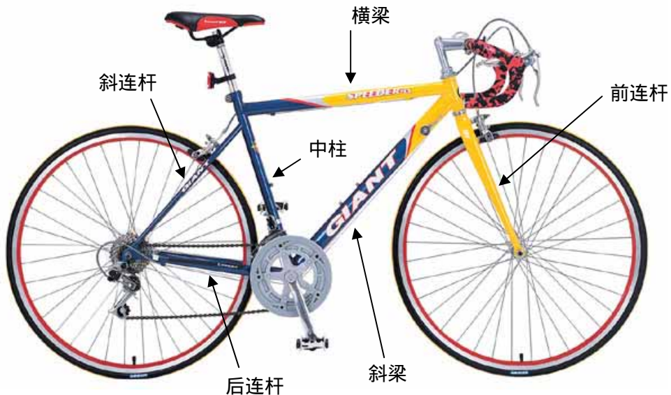
图 1 自行车杆系骨架命名约定
