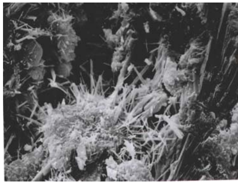
图 2：水泥浆扫描电镜照片（7 天龄期）
