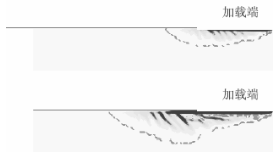
图 5：外贴 FRP 下混凝土裂缝的发展过程 [4]
